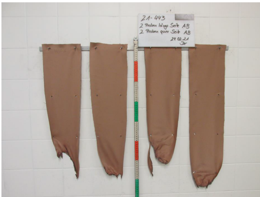
Bild 2: Aussehen der Proben nach dem Brandversuch
